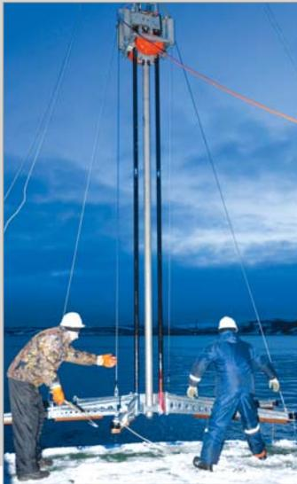
Рис. 2. Погружная система пробобора
