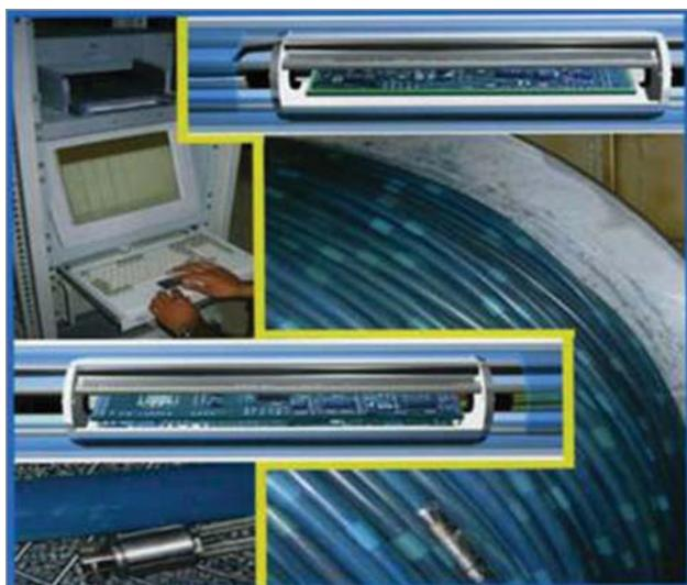
Рис. 3. Российская 192-канальная цифровая коса модели XZoneBottomFish производства компании «Си Технолджи Инструмент»
