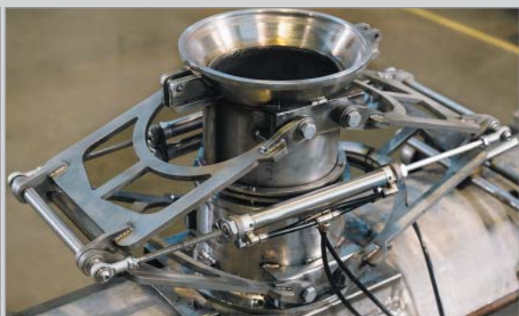
Рис. 3. Устройство слива нефтепродуктов из вагонов-цистерн УСН, герметичное, прямооточного типа, исключающее застывание продукта и посторонних предметов
