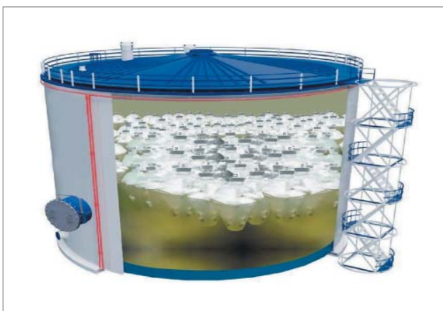
Рис. 6 Расположение плавающих понтонов для уменьшения потерь легких углеводородов и нефтепродуктов на зеркальной площади внутри резервуаров в разрезе
