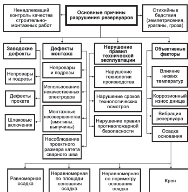
Рис. 1. Основные причины разрушения резервуаров
