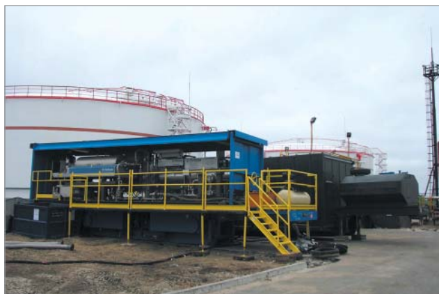
Рис. 13. Трикантерная установка Flottweg в составе системы зачистки резервуаров от донного осадка
